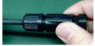
Verwenden Sie dann einen Schraubenschlüssel, um den Druckdom wie unten gezeigt fest auf die Buchse und den Stecker zu schrauben.
